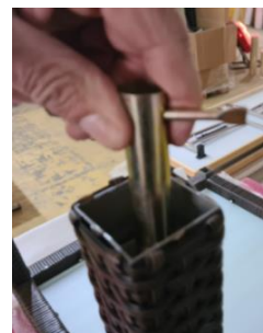
Tischbein mit Schraube und Unterlegscheiben befestigen und festziehen
