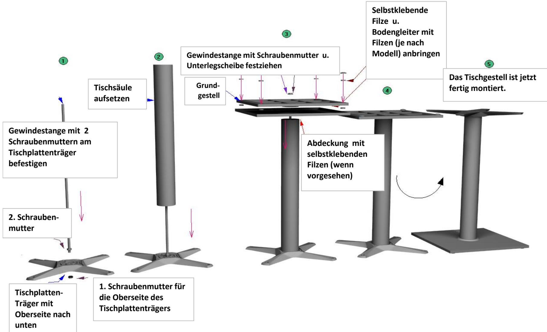
**Hinweise:** Bevor Sie das Gestell umdrehen, montieren Sie je nach Modell entweder die Kunststoffgleiter oder die Bodenausgleichsschrauben in die dafür vorgesehenen Stellen auf der Unterseite des Gestellfußes (siehe Abb. 3).
